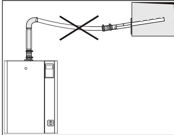
Illustration 27 - Installation erronée de la sortie de vapeur
