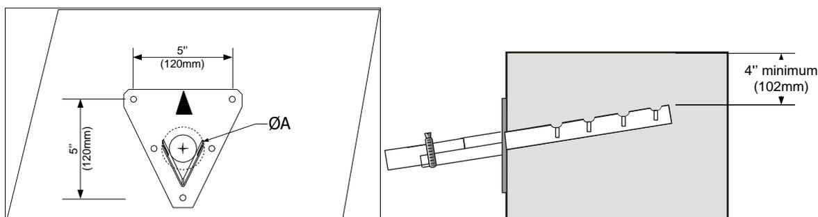
Illustration 20 - Dimension du trou dans le conduit et distance minimum
