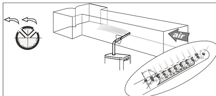
Illustration 17 - Distributeur S.A.M.E2 dans conduit horizontal
