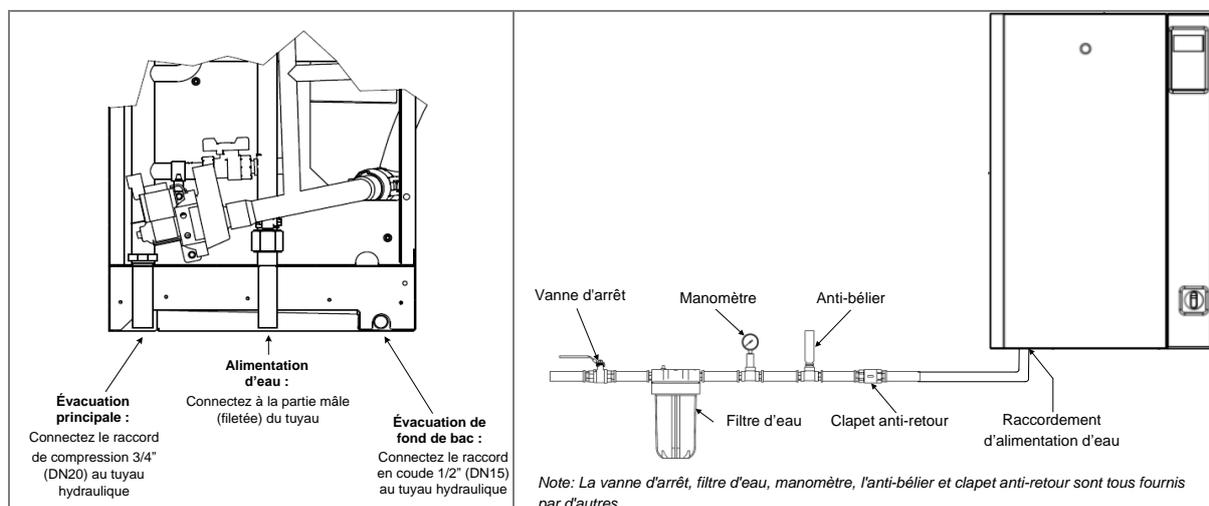
Illustration 31 - Raccordement d'alimentation et d'évacuation d'eau
