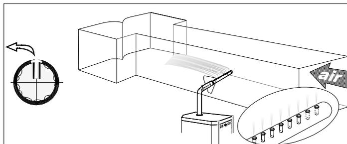
Illustration 16 - Distributeur S.A.M. dans conduit horizontal
