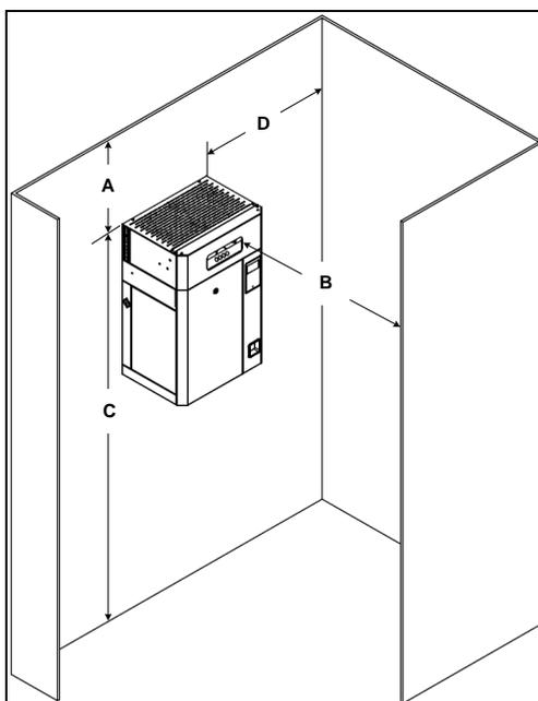
Illustration 11 - SDU installé sur l'humidificateur
