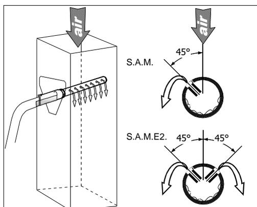
Illustration 18 - Distributeur S.A.M. ou S.A.M.E2 dans conduit vertical
