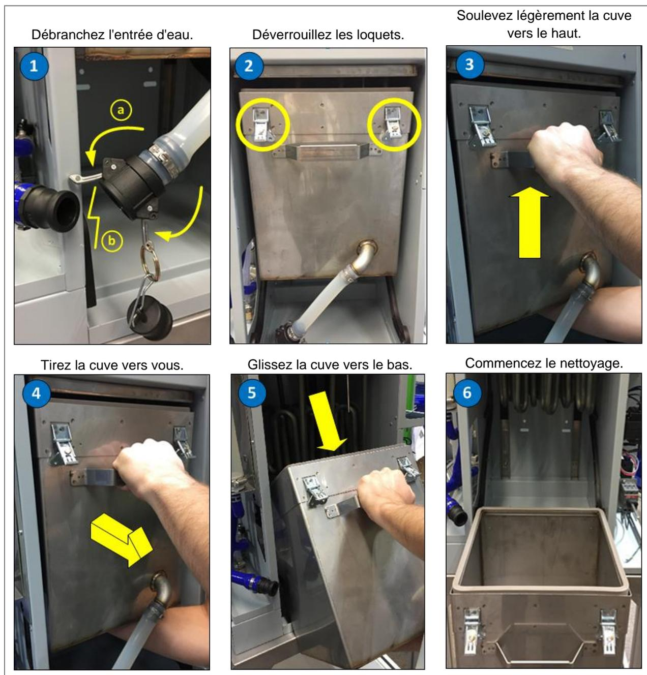
1. Avec la porte d'accès avant enlevée, débranchez l'entrée d'eau fixée à l'avant de la chambre d'évaporation, en retirant les goupilles de sécurité et en déconnectant manuellement le raccordement du tuyau d'entrée d'eau de la section de plomberie de l'humidificateur. Connectez et fixez le bouchon d'eau à l'entrée, afin d'empêcher l'eau de s'échapper de la chambre d'évaporation.
